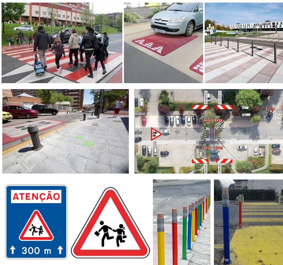
Figura 5. Tipologias de medidas de acalmia de tráfego e de sinalização horizontal e vertical para entornos escolares
