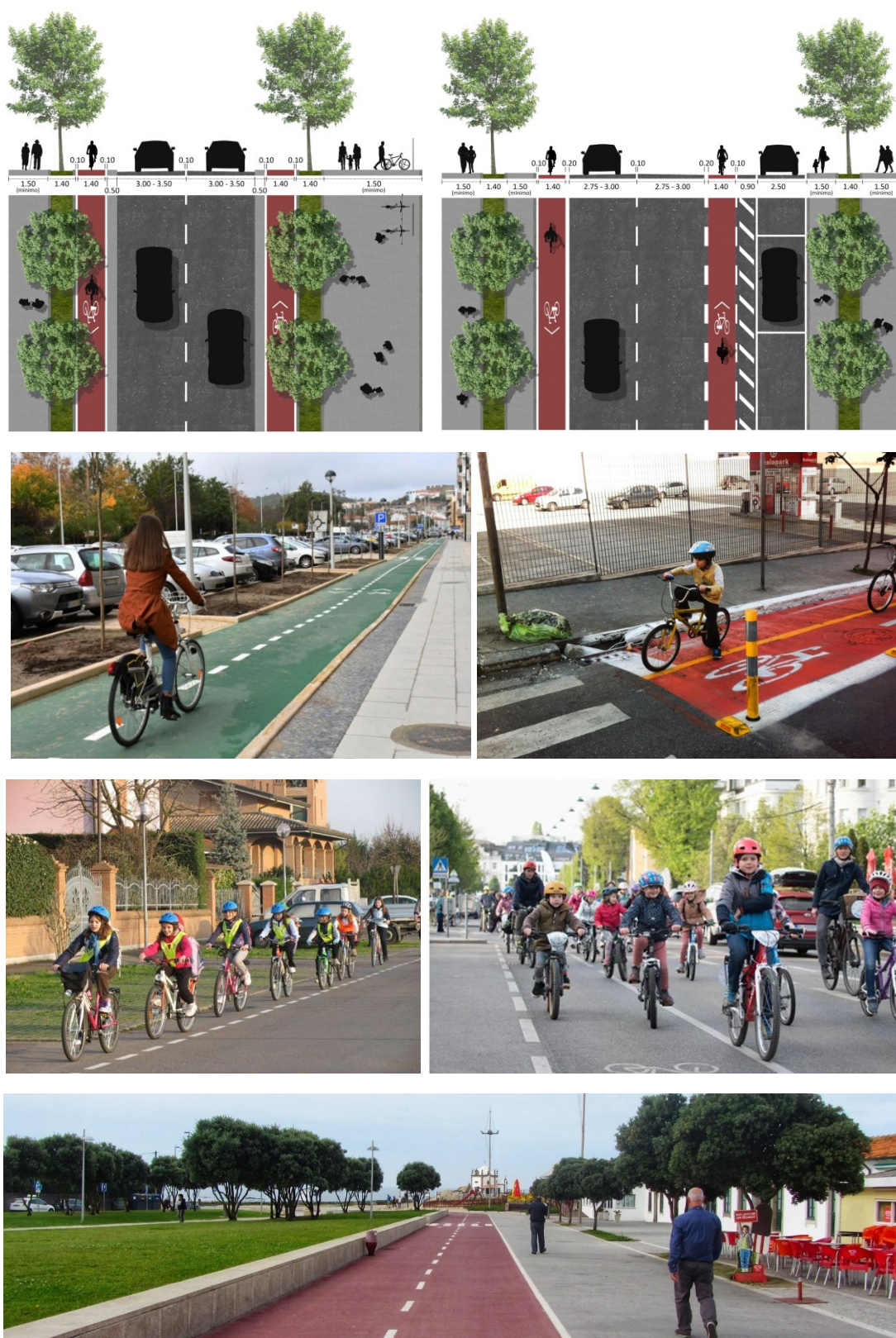
Figura 11. Tipologias de perfis-tipo devidamente dimensionados e diferentes canais cicláveis implementados em territórios diversos
